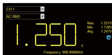
DVM测量窗口监控 1KHz · 2.5Vpp 的方波
