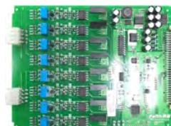
直流电压测量卡
