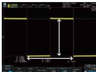
使用 \Delta T & \Delta V 光标同步测量电平和时间差
