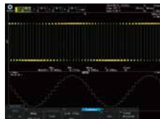
波形参数的趋势图显示 使用时间轴的直方图显示
