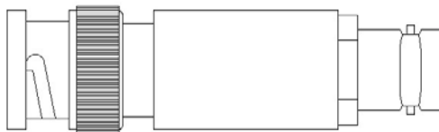
图 5 标配 50 \Omega 负载：频率：DC-1GHz；最大输入功率：1W
