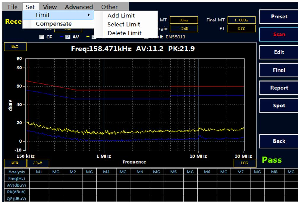
下面以国标 GB 9254-2008/CISPR 22: 2006 信息技术设备的无线电骚扰限值 and 测量方法（即 EN55022 标准）为例，分别添加 QP 线和 AV 线。该标准给出的 B 级传导限值如下：
