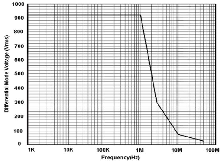
图 1: 最大差模电压 VS 频率曲线
