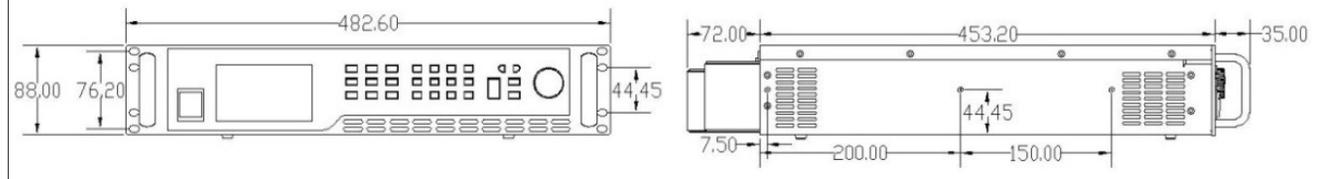
4. 8kW、6. 5kW机型尺寸图（10V、20V机型）：
