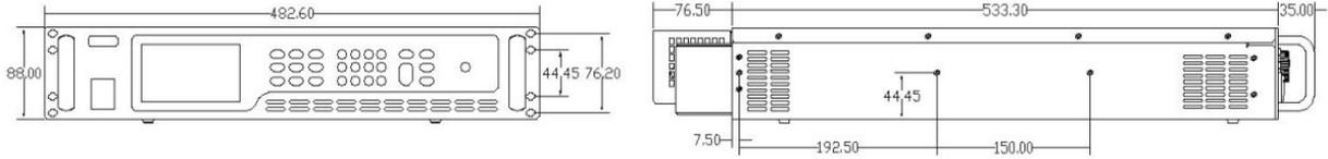
2kW、3. 2kW机型尺寸图（40V~1500V机型）：
